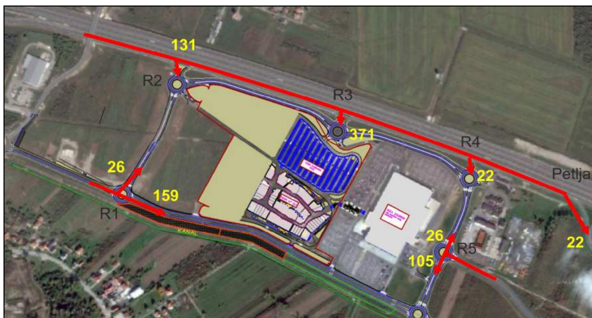
Slika 3.10-6. Prikaz raspodjele prometa tijekom 4 vršna sata subotom Izvor: Izradio autor temeljem Studija Dinamičko brojenje dolaznih prometnih tokova
